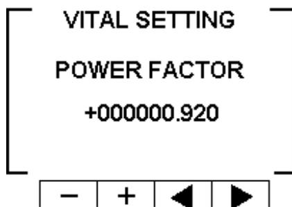
Рисунок 3.6 - Изменение значений коэффициента мощности.
